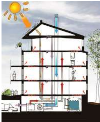
Figur 2. Skiss av Hamnhuset i genomskärning. Hamnhusets installationer är utritade i skissen, t.ex. syns solfångarna på taket och ackumulatortankarna i källarplan. I källaren syns även FTX-aggregat. (Älvstanden Utveckling AB 2010) med tillstånd.
